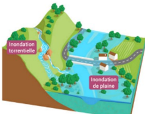
Inondation par débordement
